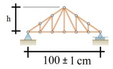
✓ La carga de un kilogramo se desplazará a lo largo del puente hasta llegar a la mitad del mismo, donde permanecerá quieta por 60 segundos. Después, continuará su recorrido a lo largo del puente. Durante todo el recorrido de la carga móvil el puente no debe experimentar ningún colapso. Para cumplir con este requisito, se debe diseñar el puente de manera que tenga un ancho libre de 13 cm y una altura libre de 13 cm, para permitir el tránsito de la carga móvil.
