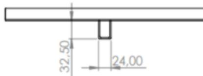
Esta pieza estará compuesta de un acero Angular de 19x19x2.5mm.
