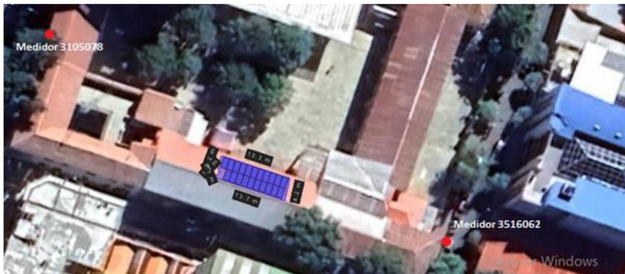
La distancia aproximada entre los paneles y el medidor N° 3516062 es de 45m, y entre los paneles y el medidor N° 3105078 es de 65m. Las coordenadas del campus son, latitud: -21.53344°, longitud: -64.73141°
